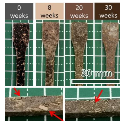
図 2. 土壌中での樹皮/PBS 試験片の外観変化
