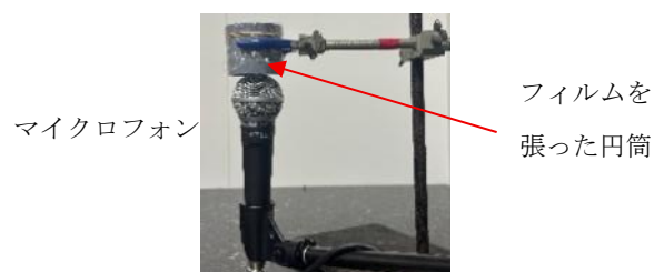
Fig. 4 フィルムを張った円筒とその打刻音を検出する方法
