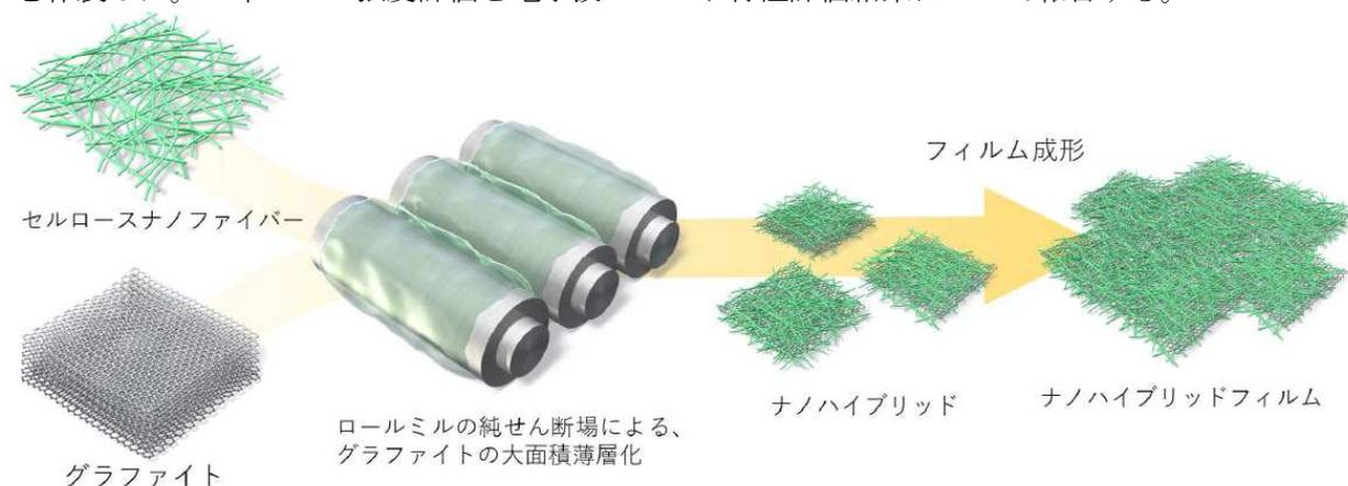
図1 ロールミルによるグラファイトの薄層化
